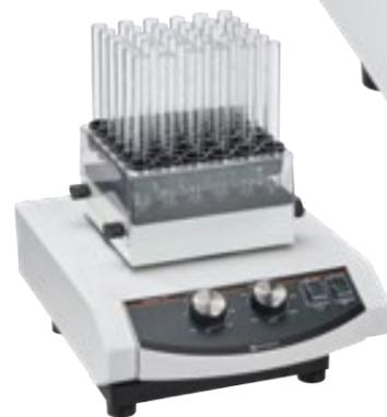
Vielfältige Möglichkeiten durch Kombination mit Spannwalzen und Halteklammern sowie optionale Reagenzglasaufsätze mit bis zu 49 Proben gleichzeitig.
