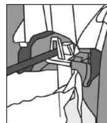
Setzen Sie die Einwegpumpe mit Verpackung in der Hand in den Wandspender plus ein
