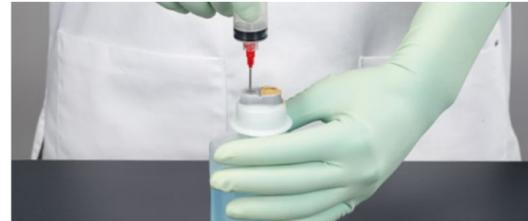
Wird die Kanüle nach dem Zuspitzen aus dem Behälter herausgezogen, entsteht im Schaft ein leichter Unterdruck, durch den ein Tropfen aus der Kanüle entweicht. Dies lässt sich vermeiden, indem man den Schaft der Kanüle mit Luft füllt, bevor sie aus dem Behälter entfernt wird. Die Twincap® dichtet nach dem Entfernen der Kanüle automatisch wieder ab.
